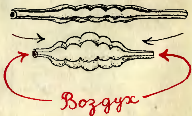
Цепочка эластичных камер вполне выполнит роль мышечного волокна.
